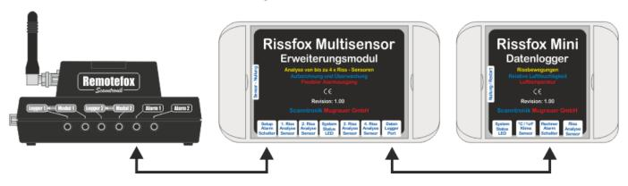
Die folgende Grafik zeigt wie der Rissfox Mini + Rissfox Multisensor mit dem Remotefox verbunden werden muss, um sowohl die gesammelten Messdaten des Gesamtsystems zu erhalten, als auch im Alarmfall via eMail und/oder SMS informiert zu werden:
