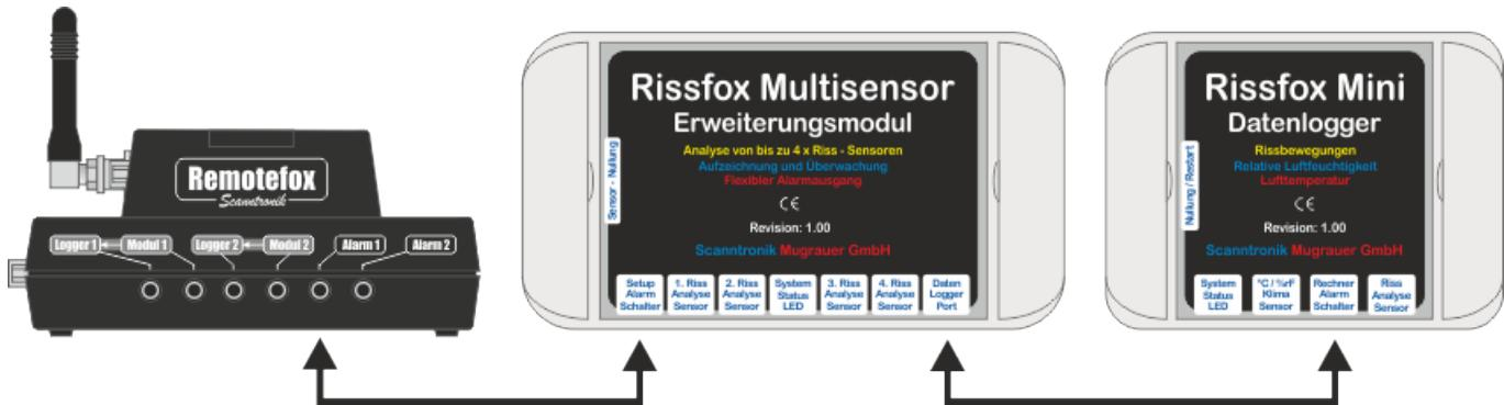
Die folgende Grafik zeigt wie der Rissfox Mini + Rissfox Multisensor mit dem Remotefox verbunden werden muss, um sowohl die gesammelten Messdaten des Gesamtsystems zu erhalten, als auch im Alarmfall via eMail und/oder SMS informiert zu werden:
