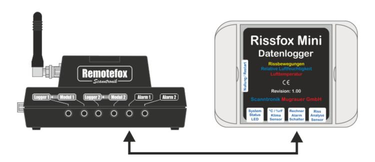
Die folgende Grafik zeigt wie der Rissfox Mini mit dem Remotefox verbunden werden muss, um sowohl die gesammelten Messdaten des Rissfox Mini's zu erhalten, als auch im Alarmfall via eMail und/oder SMS informiert zu werden:
