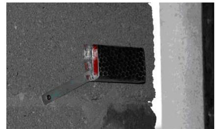
Abb. 7: Marderschutz für den PIR-Datalogger Foto: HOLGER KÖRBER
