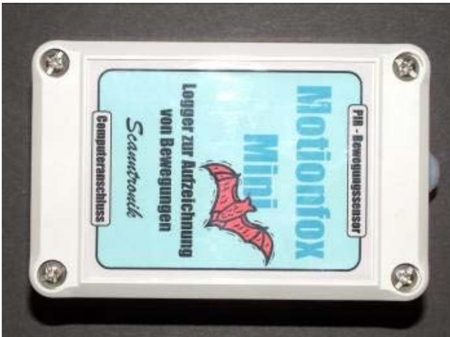
Abb. 5: Datalogger mit PIR-Sensor zum Messen von Bewegungen (Fa.Scantronic, Zorneding)
