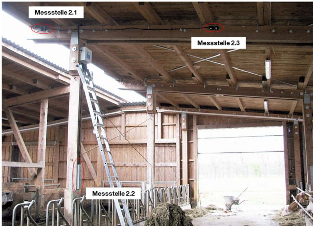
Abbildung 9: Anordnung der Messstellen des Messsystems 2
