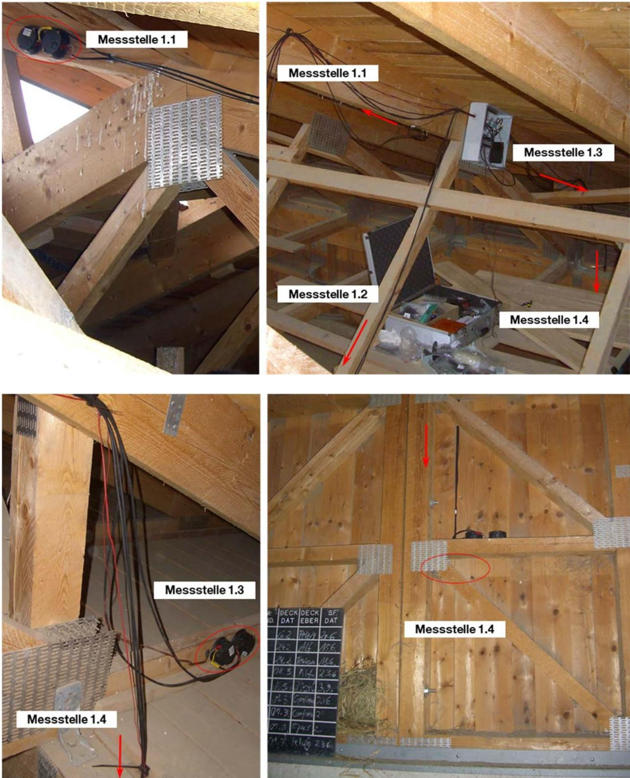
Abbildung 18: Anordnung der Messstellen des Messsystems 1 (Abteil B)
