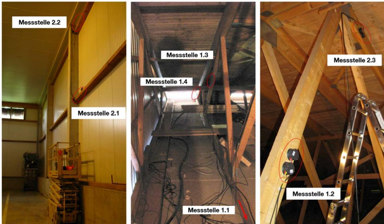
**Abbildung 25: Anordnung der Messstellen (links: Messstellen unten im Lagerraum; rechts: Messstellen in der Dachkonstruktion)**
