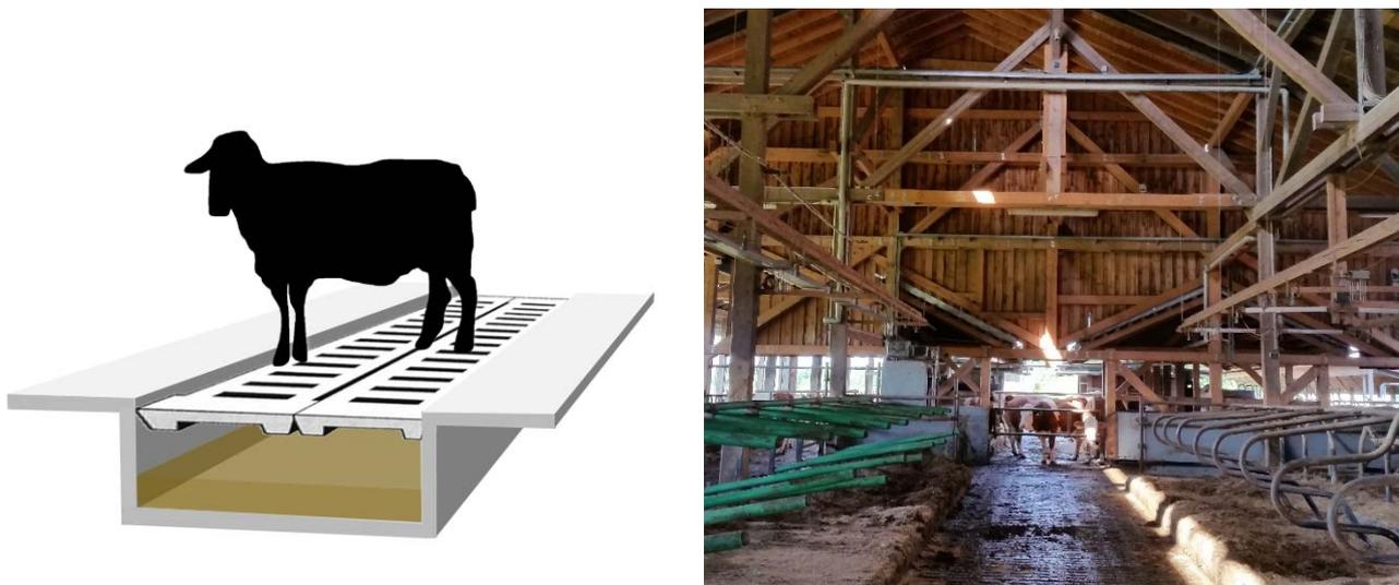
Abbildung 4-2: Links: Funktionsprinzip eines Spaltenbodens; Rechts: Spaltenboden des Objekts 01
