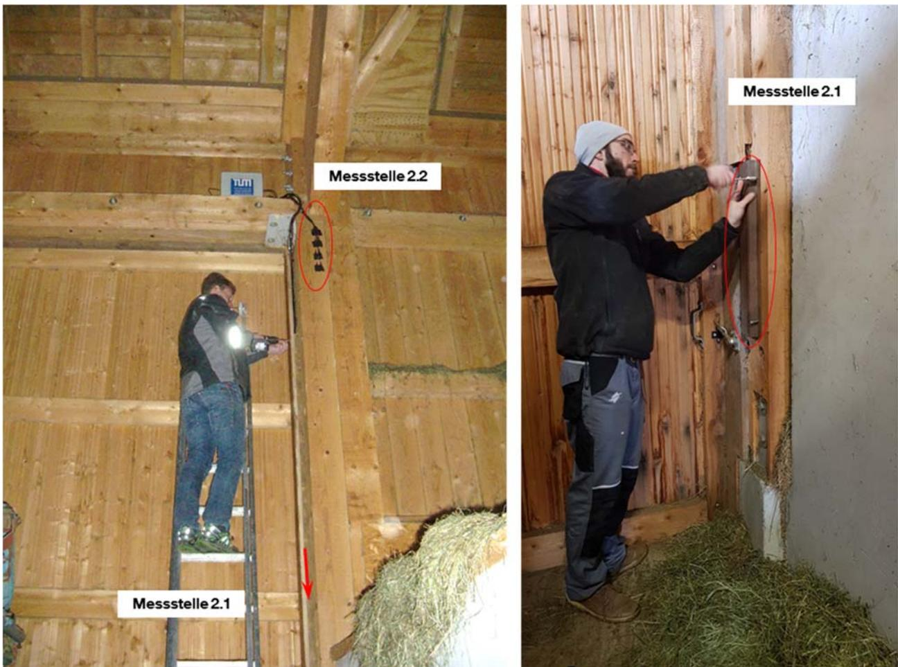
Abbildung 29: Anordnung der Messstellen des Messsystems 2
