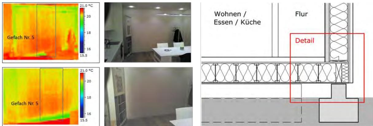
BILD 7-1 IR-THERMOGRAMME UND ZUGEORDNETE FOTOS VON DER NNO-AUßENWAND IM ERDGESCHOSS BEI NATÜRLICHEM LUFTDRUCK IM GEBÄUDE MIT KENNZEICHNUNG VON GEFACH 5 MIT MESSFÜHLERN
