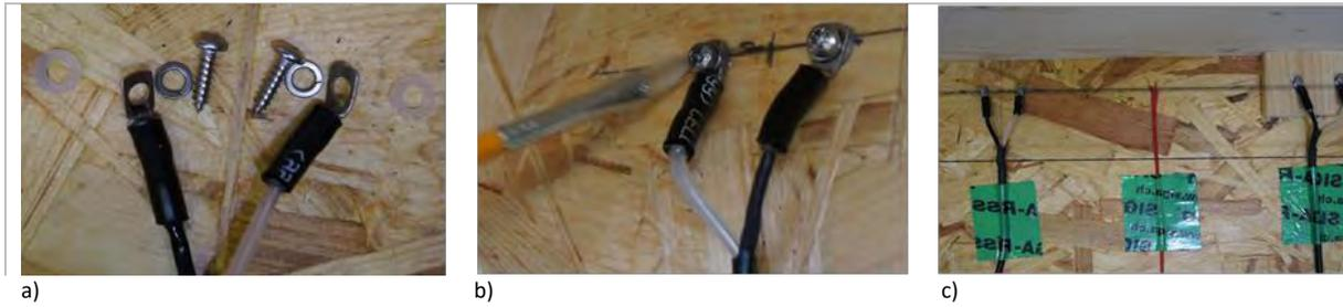
BILD 6-4 FOTOS ZUR BAUWEISE UND ANORDNUNG DER ELEKTRODEN ZUR MATERIALFEUCHTEMESSUNG IN OSB-PLATTEN UND IN FICHTENHOLZ (A, B) SOWIE ZUR LAGE DER ZUGEORDNETEN NTC-FÜHLER ZUR TEMPERATURMESSUNG (C)
