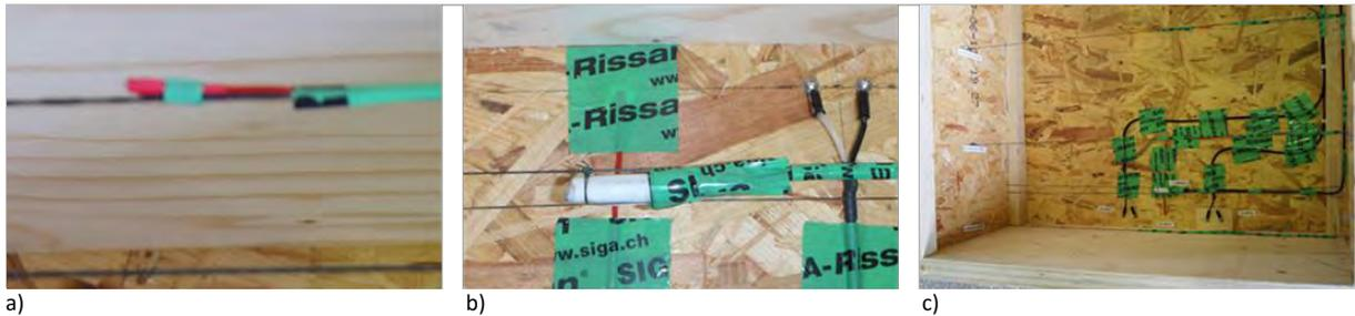
BILD 6-3 A) TEMPERATURFÜHLER IM DÄMMSTOFF, B) DER KAPAZITIVEN LUFTFEUCHTEFÜHLER (SCHUTZVLIES GEGEN STAUB) IM DÄMMSTOFF, C) FÜHLER AM FUßPUNKT VON GEFACH NR. 5 DER NNO-AUßENWAND - A) UND B) IN LAGE GEHALTEN AN GESPANNTEM FADEN
