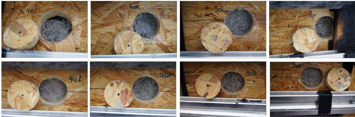
BILD 9-22 ZUSTAND DER SCHICHTGRENZE GEFACHDÄMMUNG / AUßENSEITIGE GEFACHBEPLANKUNG AN GEFACH 3 UND 4 AM 24.01.2013
