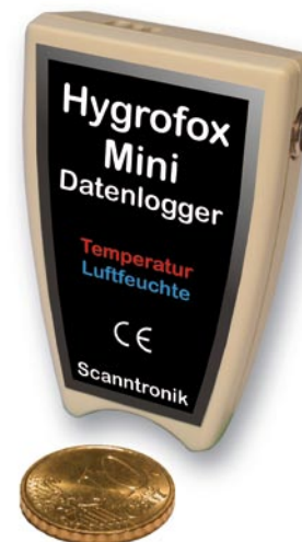
Abb. 3: Thermohygrograph zur Analyse des Raumklimas [Foto: Scantronik Mugrauer GmbH, Zorneding]
