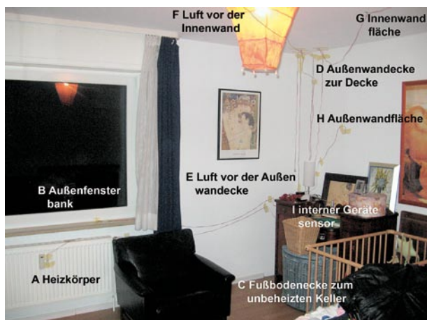
Abb. 2: Installation einer Langzeitmessung an einer Außenwand
