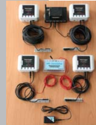
Rissbreiten-, Temperatur- und Luftfeuchtigkeitsmessungen
