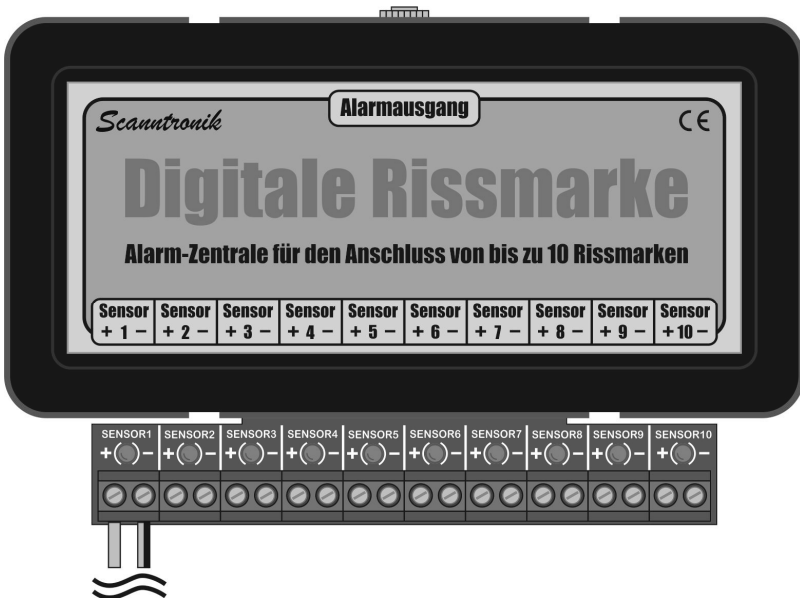
Abbildung 1: „Rissmarken – Zentrale“ mit einem angeschlossenen Sensor
