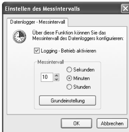
Abbildung 9: Zähl-/Messintervall des Eventfox einstellen
