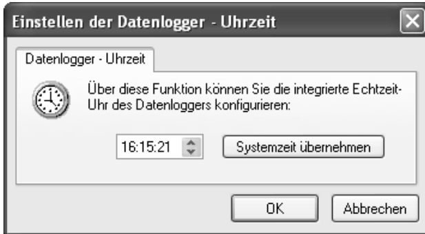
Abbildung 6: Einstellen der internen Datenlogger-Uhr
