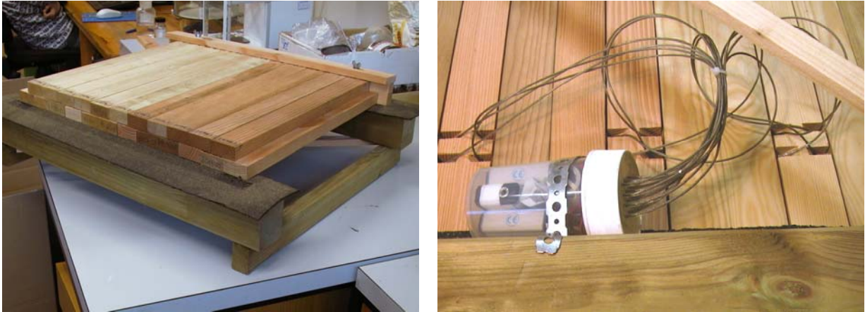
Abb. 11: Aufbau der Doppellagen-Testsets. Links: Oberseite, gegeneinander versetzte Doppellage. Rechts: Unterseite, Schutzdose mit Holzfeuchte- und Holztemperatur-Loggern.
