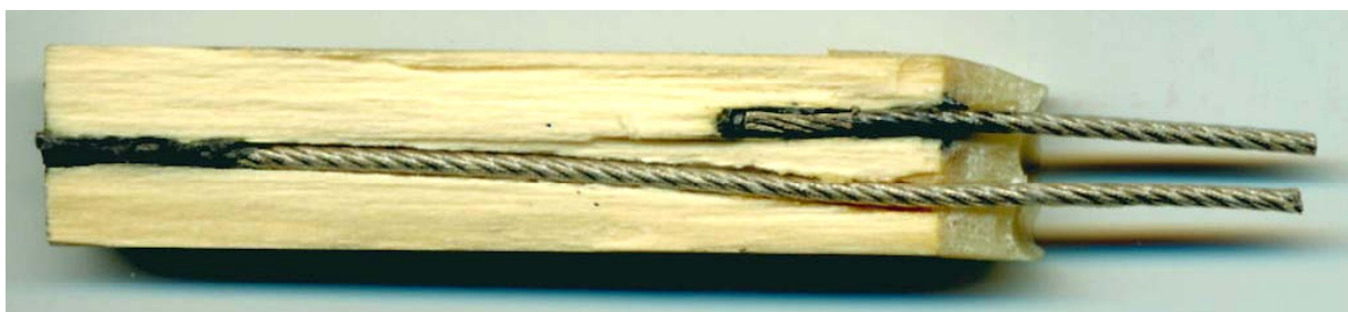
Abb. 6: Längsschnitt durch einen Holzdübel mit zwei eingeleimten Messelektroden.
