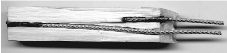
Abb. 3. Längsschnitt durch einen Messdübel aus Kiefernspint, imprägniert mit einem Tebuconazol-haltigen Holzschutzmittel, einschließlich einem Paar eingeleimter Messelektroden.
