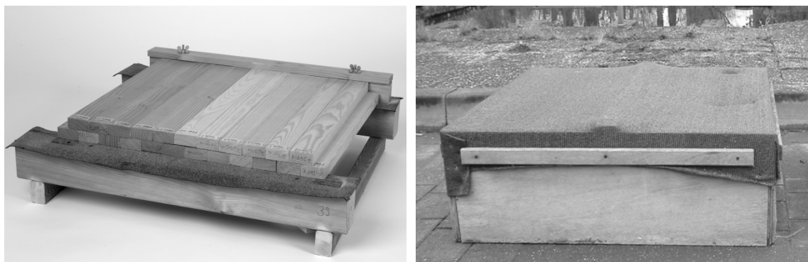
Abb. 4. Links: Doppellagen-Testset, in dem die obere Prüfkörperlage horizontal um 25 mm zur unteren Lage versetzt ist. Prüfkörper werden durch Bitumenschweißbahn von den CKB-imprägnierten Auflagern getrennt. Rechts: Künstliche Beschattung eines Doppellagen-Testsets durch ein Textilgewebe.
