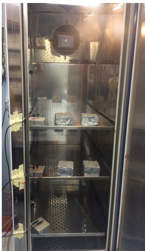
Fig 10. Campioni di legno e CalceCanapa in camera climatica durante la fase di precondizionamento.
